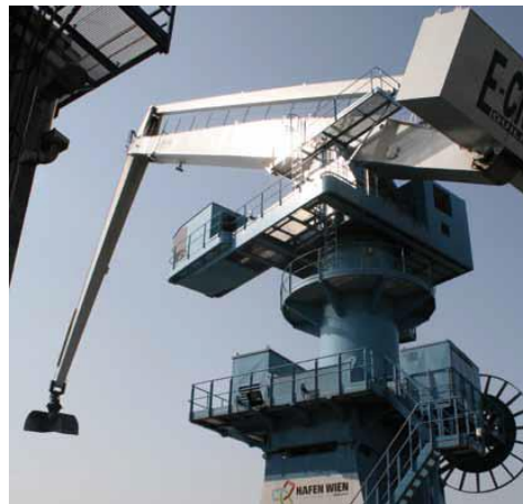
Abbildung 7 - Wippdrehkrane im Hafen Wien (Quelle: viadonau)
